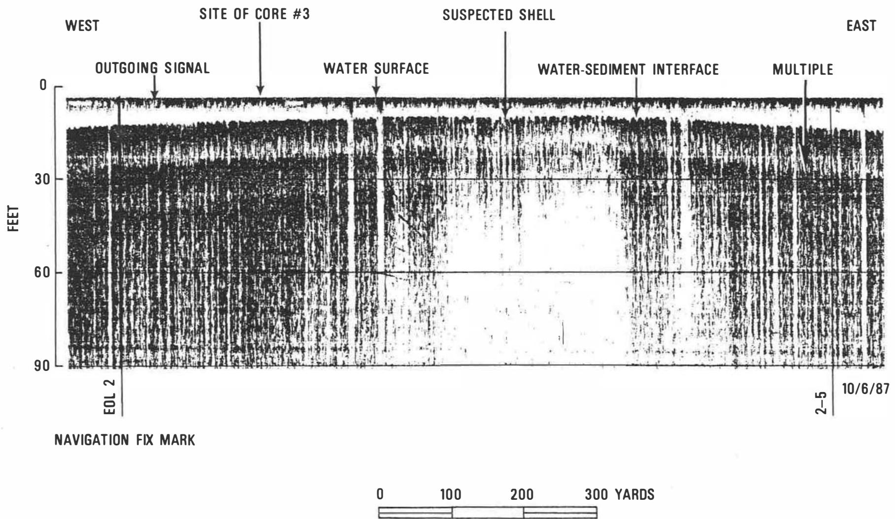
**FIGURE 7.** SECTION FROM SEISMIC RECORD ALONG TRACK LINE 3 AT MAN O'WAR SHOAL (BETWEEN LORAN FIX MARKS 3-3 AND 3-5).
